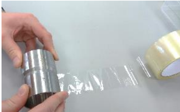
Obr. 18 Spojování Kopeckého válečků lepicí páskou.
