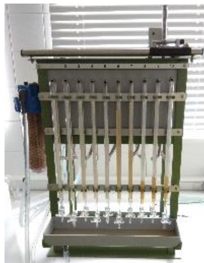
Obr. 27 Průběh měření K_s na laboratorním permeamtru.
