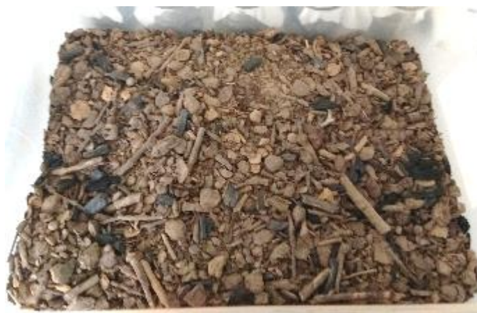
Obr. 15 Půda s přísadou kompostu a 2 % biocharu přidaných po kompostování.
