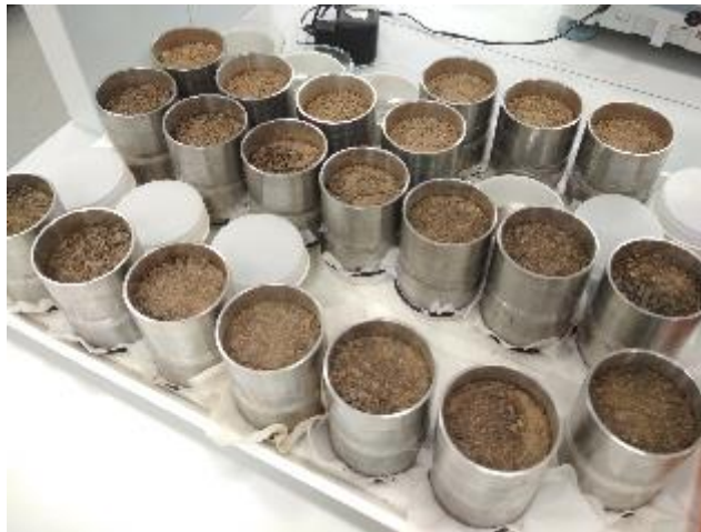
Obr. 21 Naplněné válečky a váženky.
