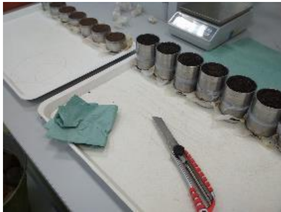
Obr. 29 Oddělování Kopeckého válečků a seřezávání zeminy.
