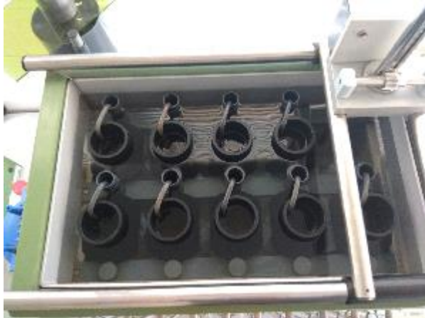
Obr. 26 Umístěné vzorky s násoskami v laboratorním permeamtru.
