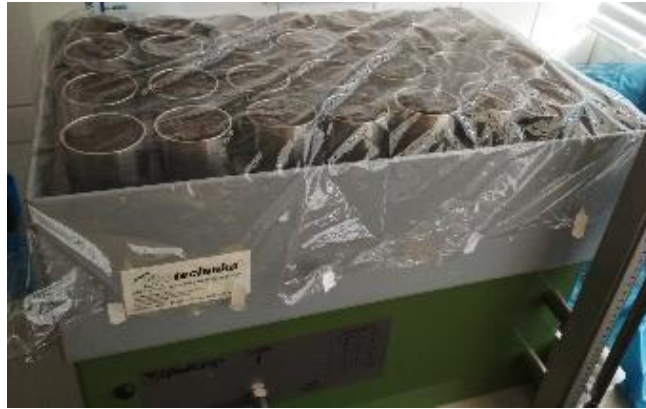
Obr. 22 Sycení vzorků v pískovém tanku.
