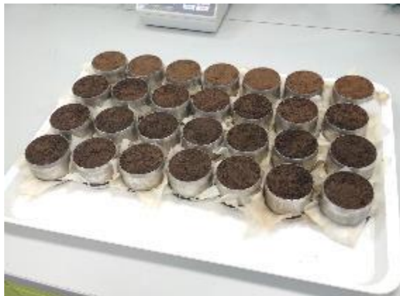
Obr. 30 Připravené vzorky pro měření.
