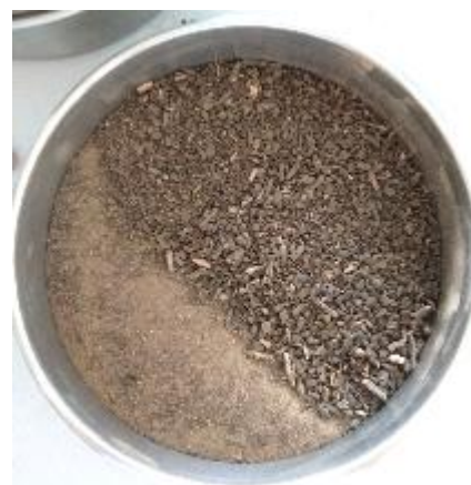
Obr. 17 Prosetá směs půdy na sítu o průměru ok 4 mm.
