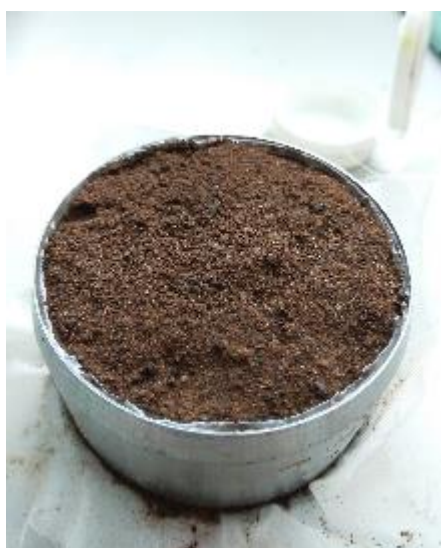
Obr. 24 Vyplnění mezer silikonem (mezi okrajem válečku a zemínou).
