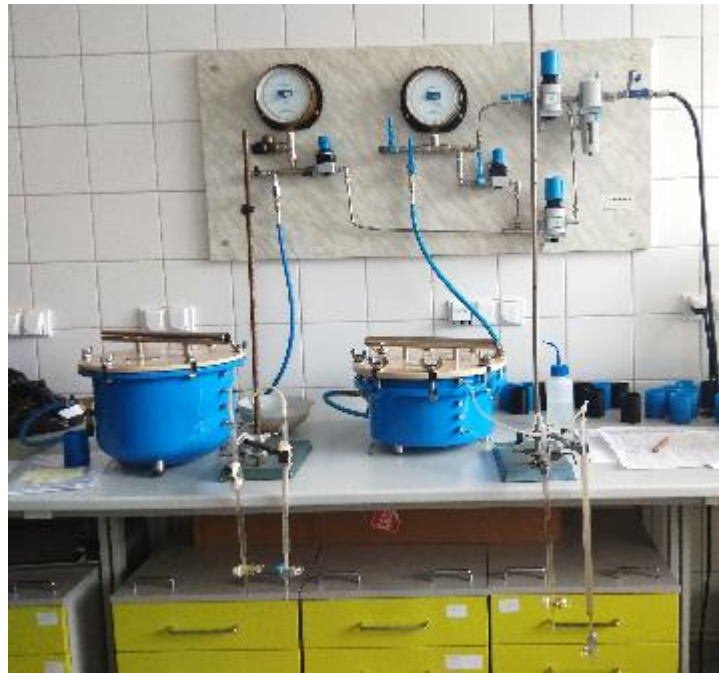
Obr. 33 Probíhající měření pF 3 na přetlakové aparatuře
