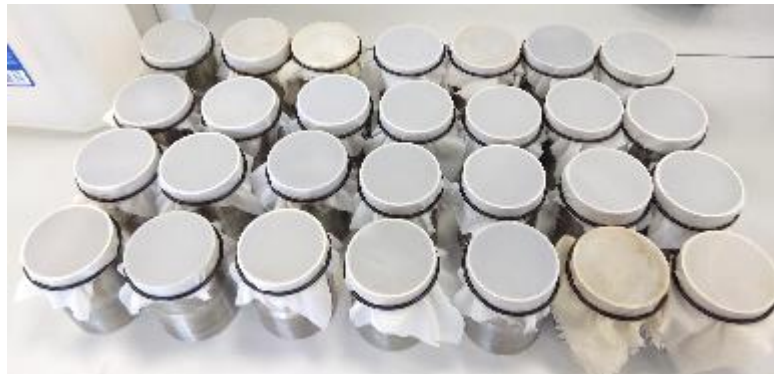
Obr. 19 Připravené válečky (upevněná látková membrána gumičkou).
