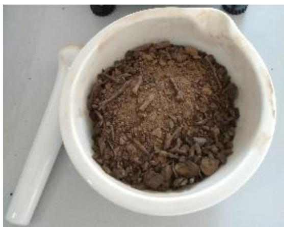
Obr. 16 Směs půdy připravená k rozmělnění ve třecí misce.
