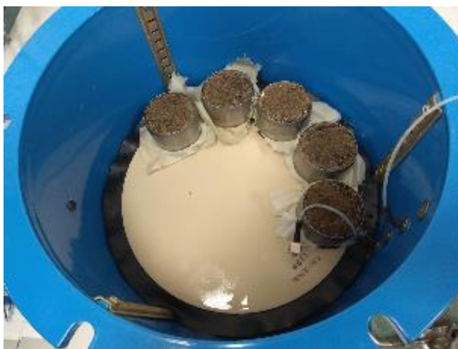
Obr. 32 Umisťování vzorků do přetlakového přístroje.
