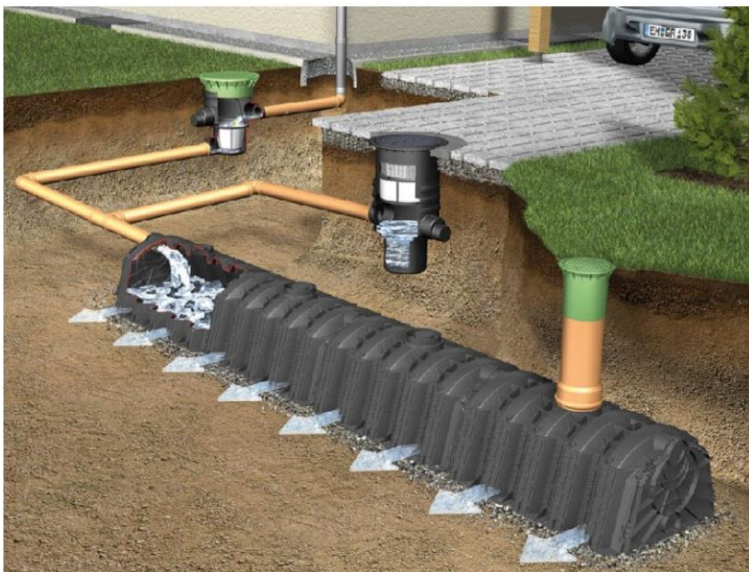
Obrázek 10: Zasakovací tunel (Dešťové nádrže ©2023)
