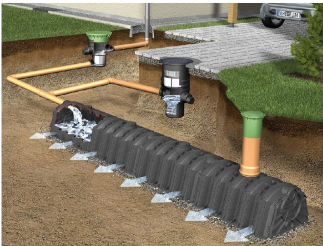
Obrázek 10: Zasakovací tunel (Dešťové nádrže ©2023)
