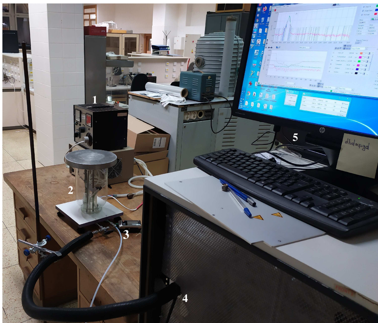
Obrázek 10 Schéma zapojení experimentální aparatury: 1 – zdroj napětí, 2 – reaktor, 3 – termočlánek, 4 – vstup do MS, 5 – PC se softwarem PTR-MS
