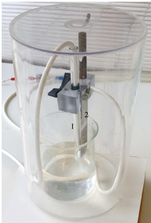
Obrázek 7 Reakční aparatura: kádinka s roztokem alkoholu a elektrodami; 1. hlavní elektroda (wolframový drát v keramice), 2. protielektroda (hliníková destička)
