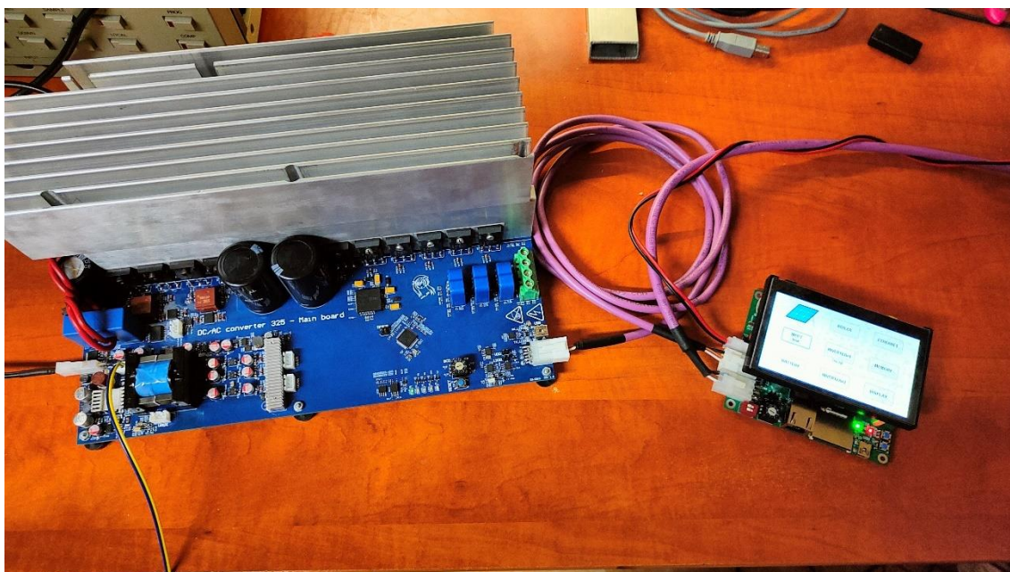
Obr. A4: Celá sestava měniče s řídicí DPS při ladění komunikačního protokolu
