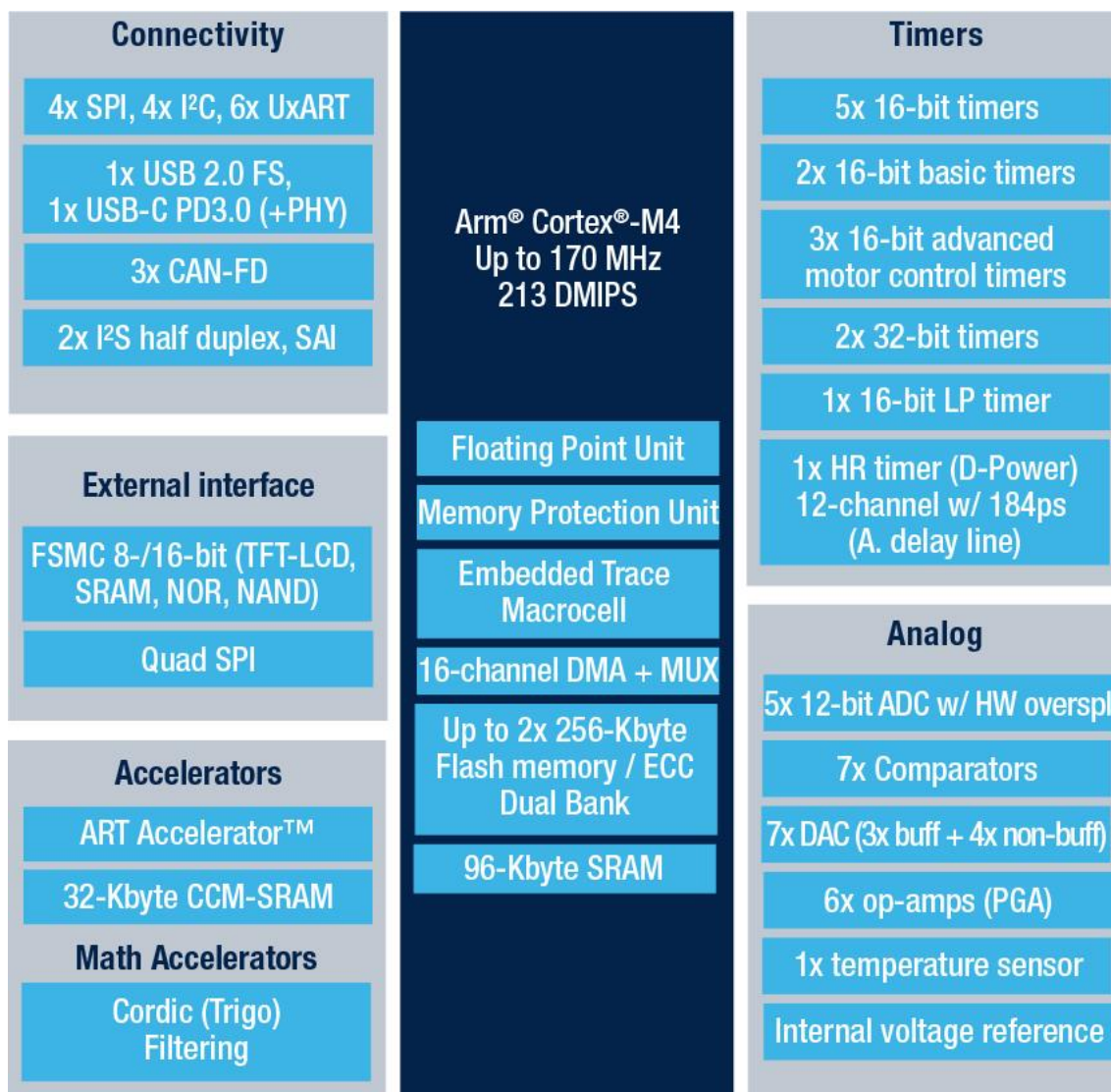
Obr. 9: Blokový popis mikrokontroléru STM32G474 [10]
