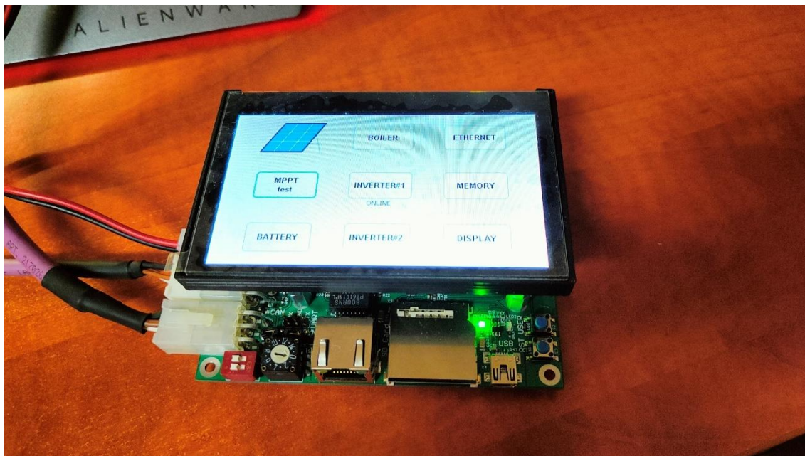
Obr. A3: Detail řídicí DPS připojené k měniči
