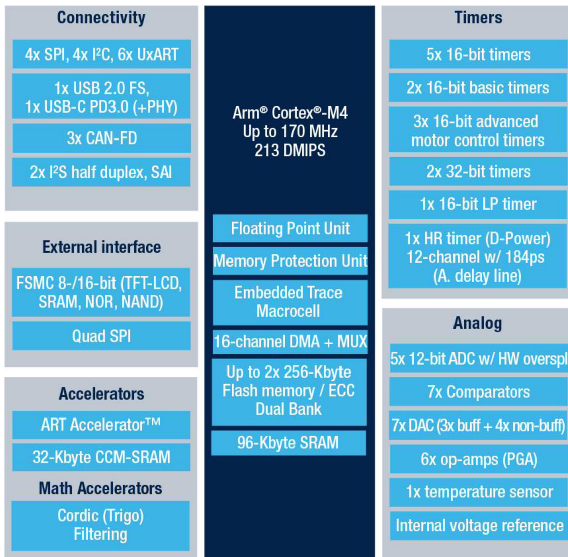
Obr. 9: Blokový popis mikrokontroléru STM32G474 [10]
