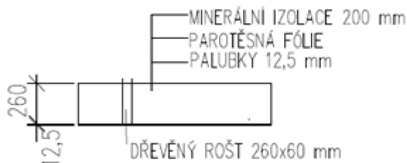
Obr. 14: Skladba konstrukce stropní konstrukce RD2 [autor]
