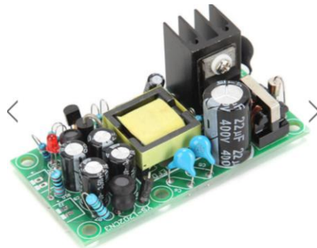
Obrázek 25 Napájecí převodník AC-DC 220V na 12V a 5V
