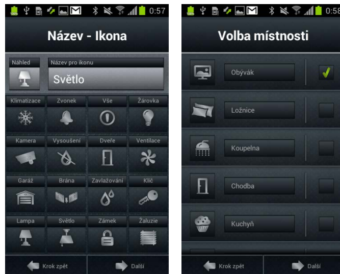
Obrázek 4.7 a) Nastavení názvu a ikony zařízení. b) Volba místnosti nebo scény, do které bude aktor zařazen.
