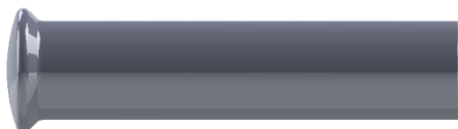
Obrázok 6.6 Zjednodušený model skrutky
