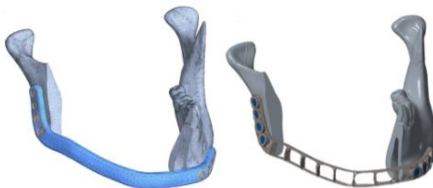
Obrázok 5.4 Personalizovaná dlaha v práci Koper a kol., pred a po topologickej optimalizácii (Prevzaté z [37])
