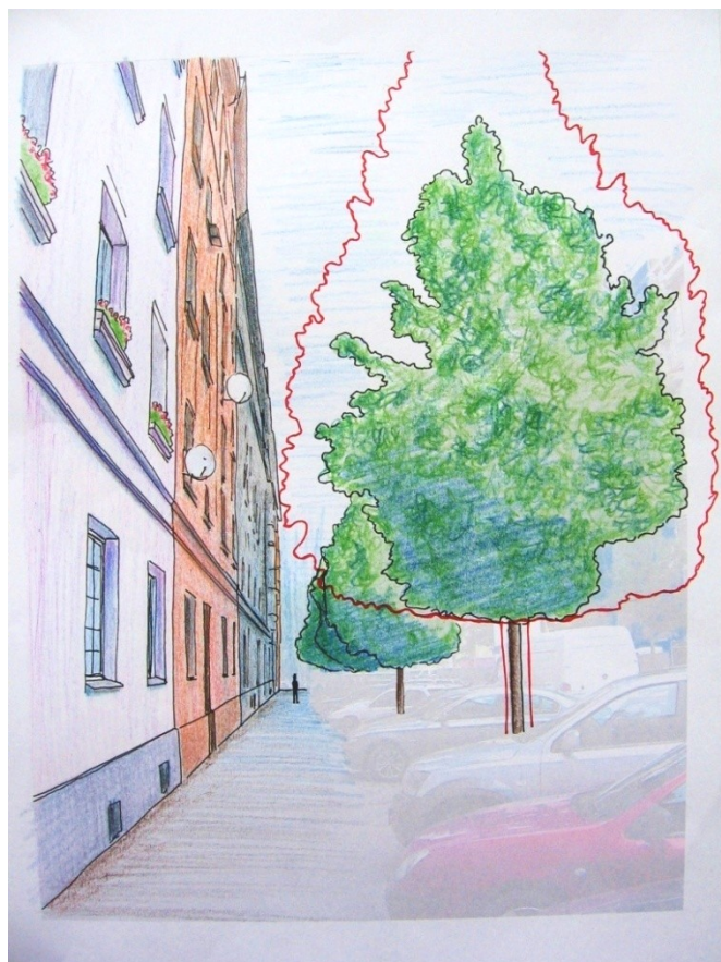
Obr. č. 12: Stromořadí Pyrus calleryana 'Chanticleer' v Eliášově ulici; vzdálenost stromů od zdí budov je 4 m
