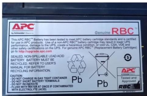
Obr. 55: Použitý olověný AGM akumulátor [Autor Dp]
