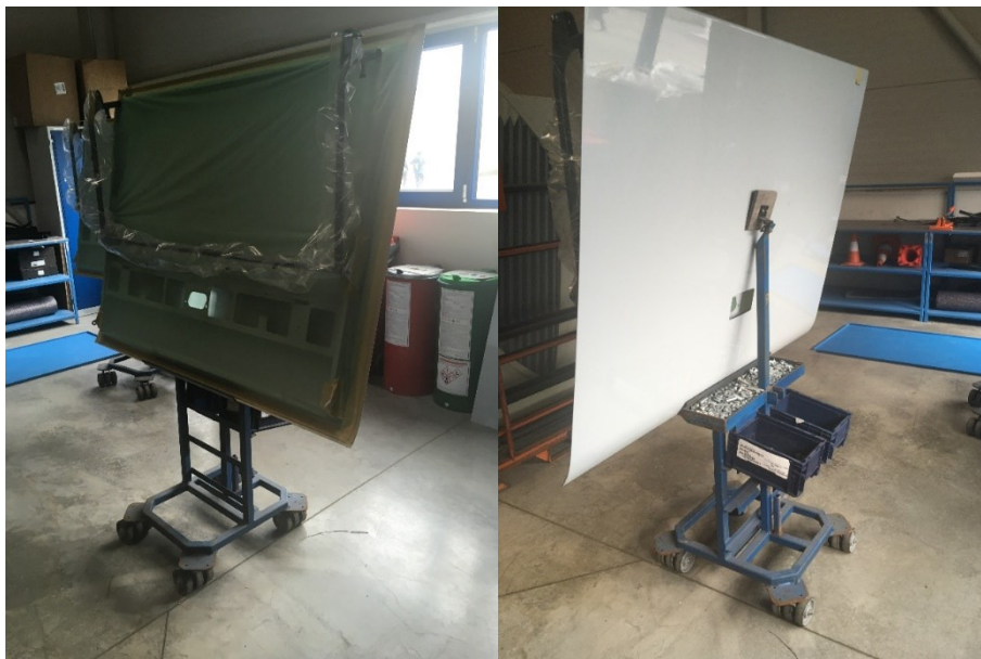
Obr. 2.5 Vozík pro montáž vík
