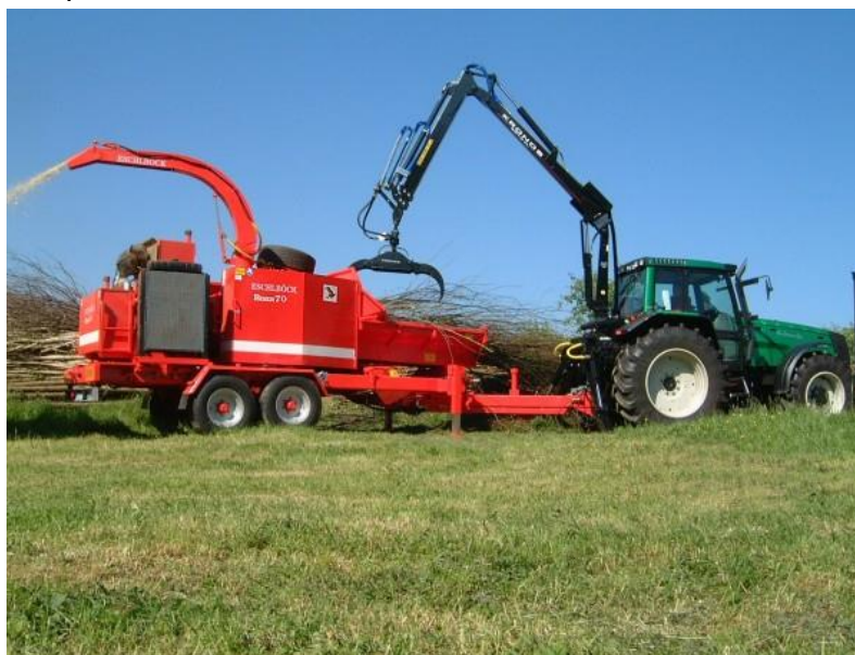
Obr. 5.6: Štěpkovač Biber 70 ZK Eschlböck
