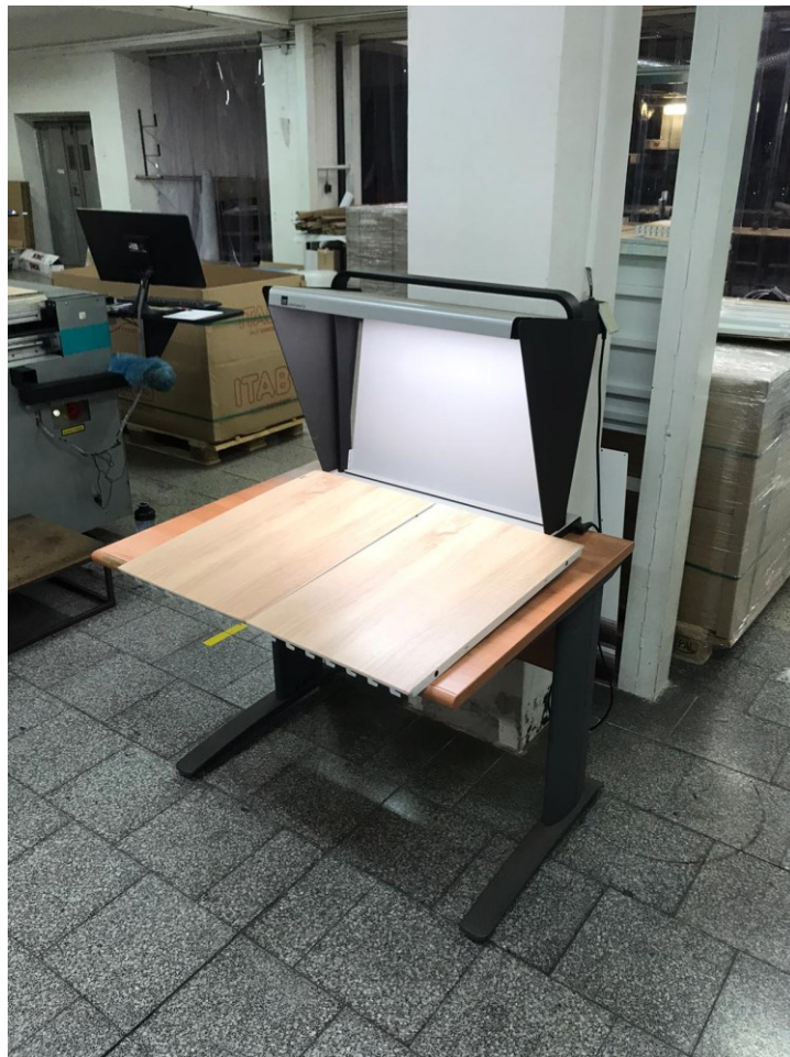
Obr. 3. 1 colorFrame 02 – kontrolní stůl s normovanou náhledovou lampou
