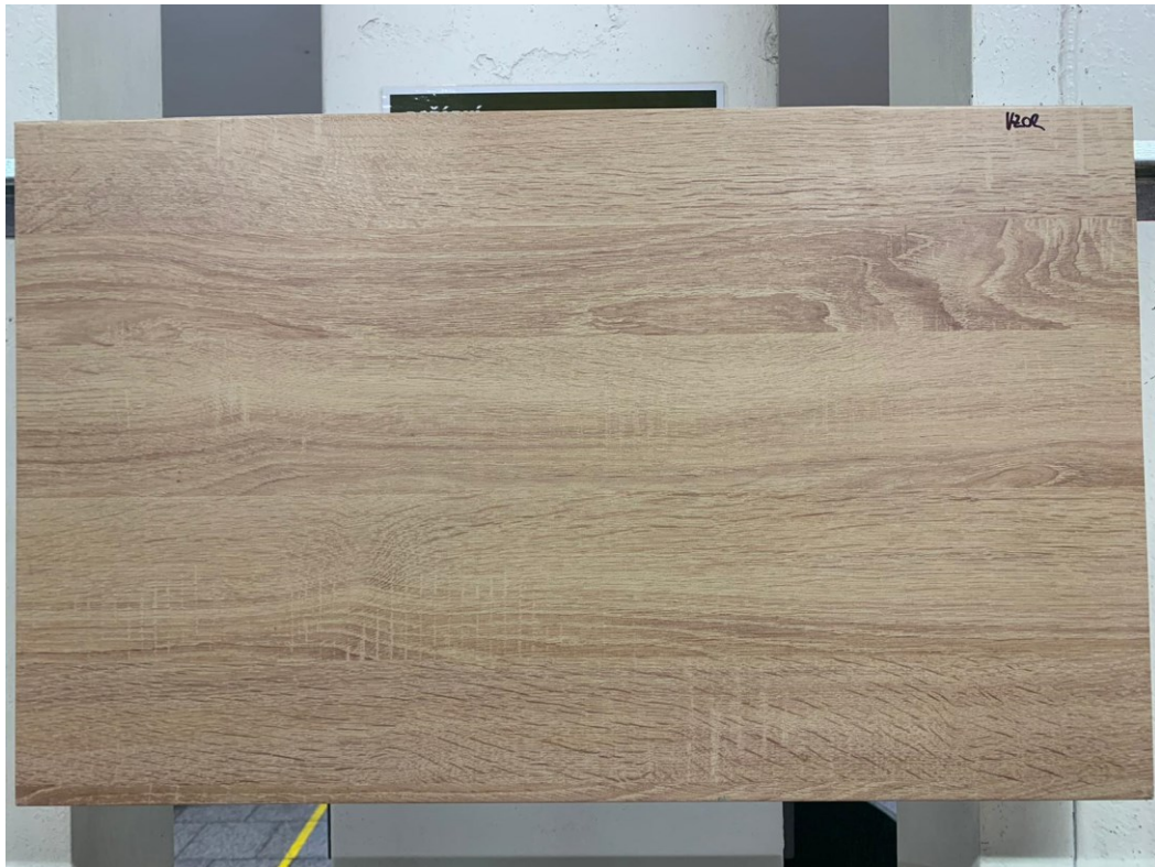
Obr. 2. 4 Potištěný vzorek zadního regálového panelu
