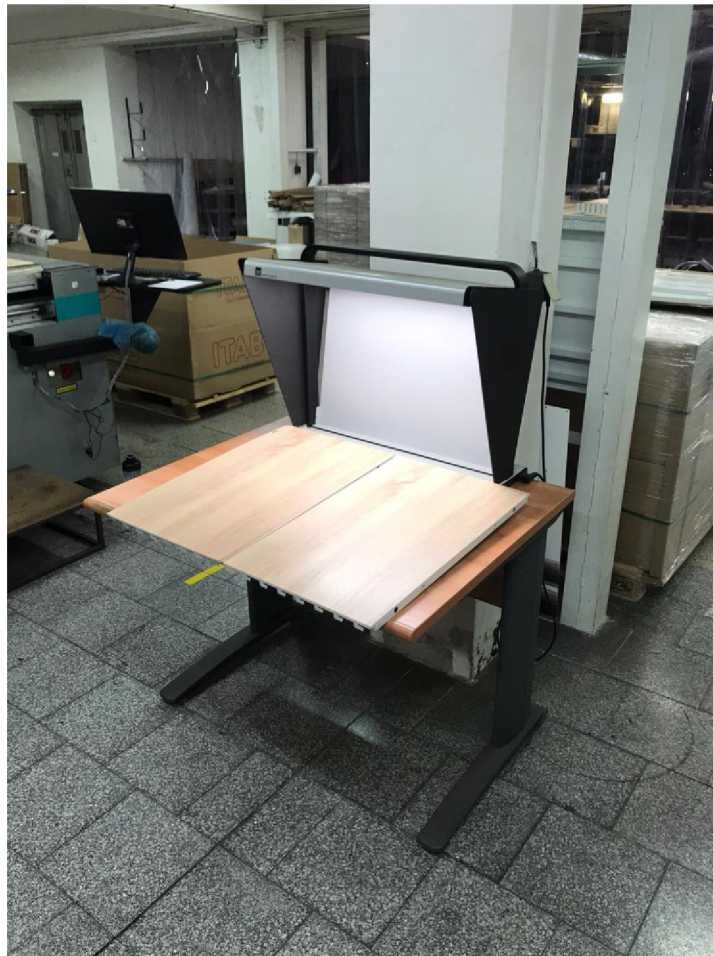
Obr. 3. 1 colorFrame 02 – kontrolní stůl s normovanou náhledovou lampou
