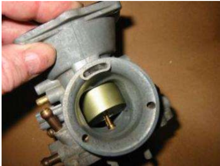
Obrázek 14: Šoupátkový karburátor, kde se šoupě využívá jak pro škrcení průtoku, tak šoupě v sobě drží jehlu, jenž ovládá průtok paliva hlavní tryskou.
