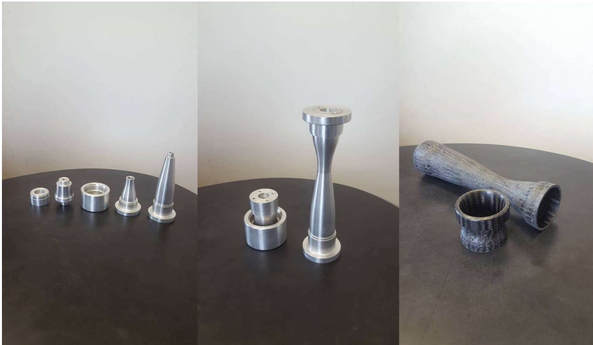
Obrázek 27: Dvoudílná hliníková forma restriktoru a nátrubku sání a hotové výrobky.
