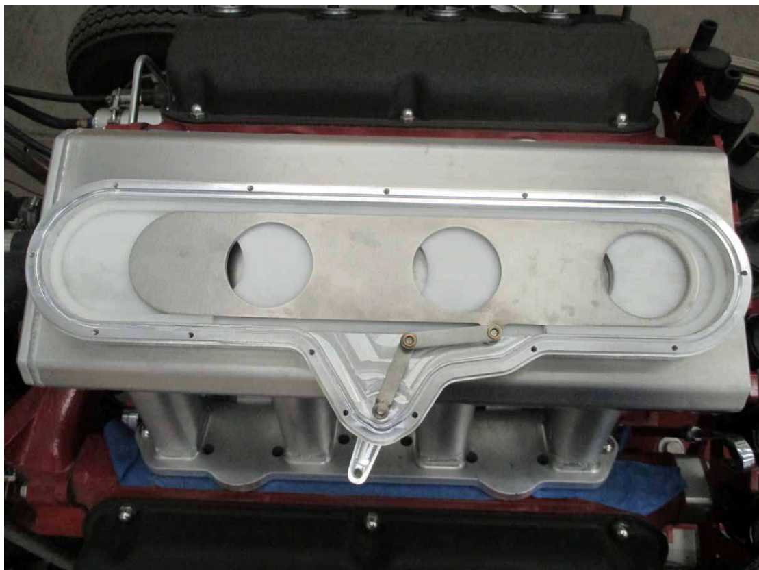
Obrázek 13: Ukázka šoupátkové klapky, sestava v rozdělaném stavu pro ukázku principu funkce [ 6 ]
