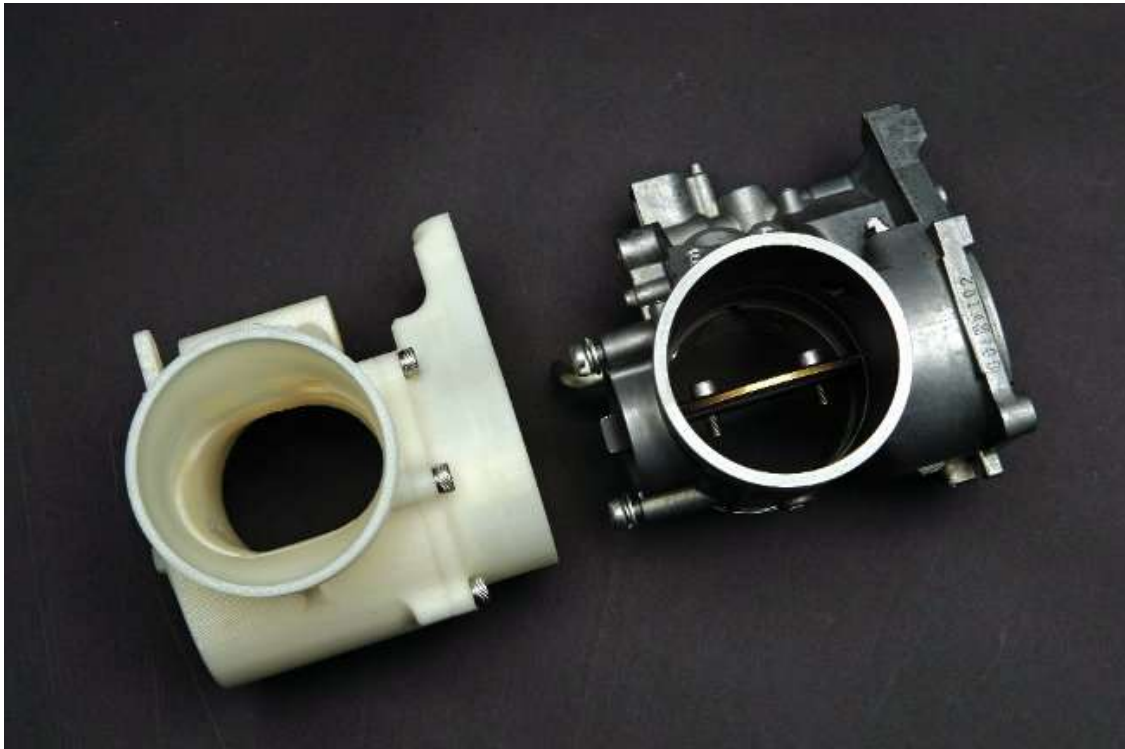
Obrázek 17: Soudečková a motýlková klapka při plném otevření. [ 9 ]
