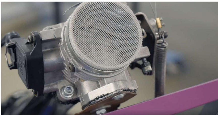
Obrázek 11: Původní škrtkičí klapka na formuli Eliška o průměru 57mm. Převzata z osobního vozu Opel Astra 1,6.
