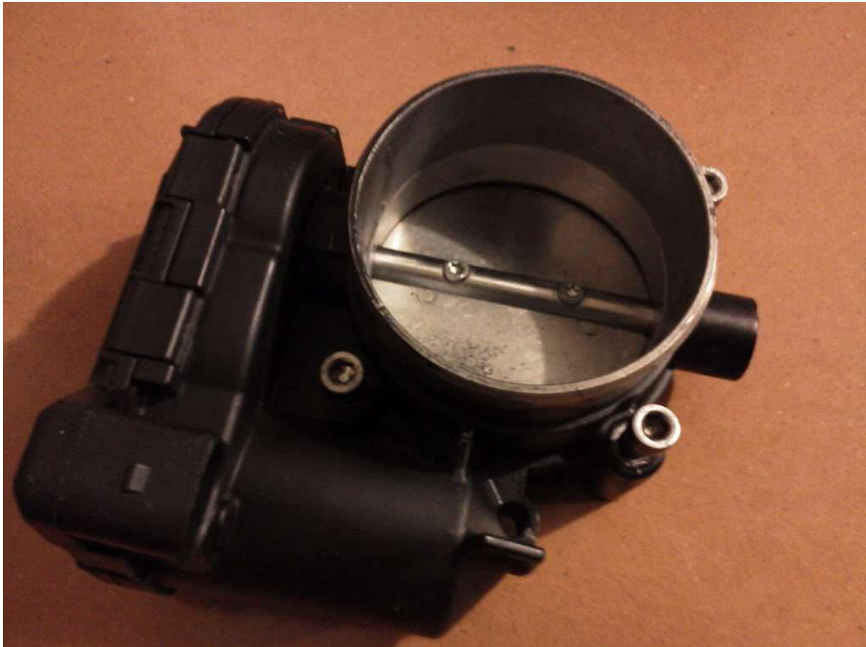
Obrázek 18: Motýlková škrticí klapka (zavřená). [ 10 ]
