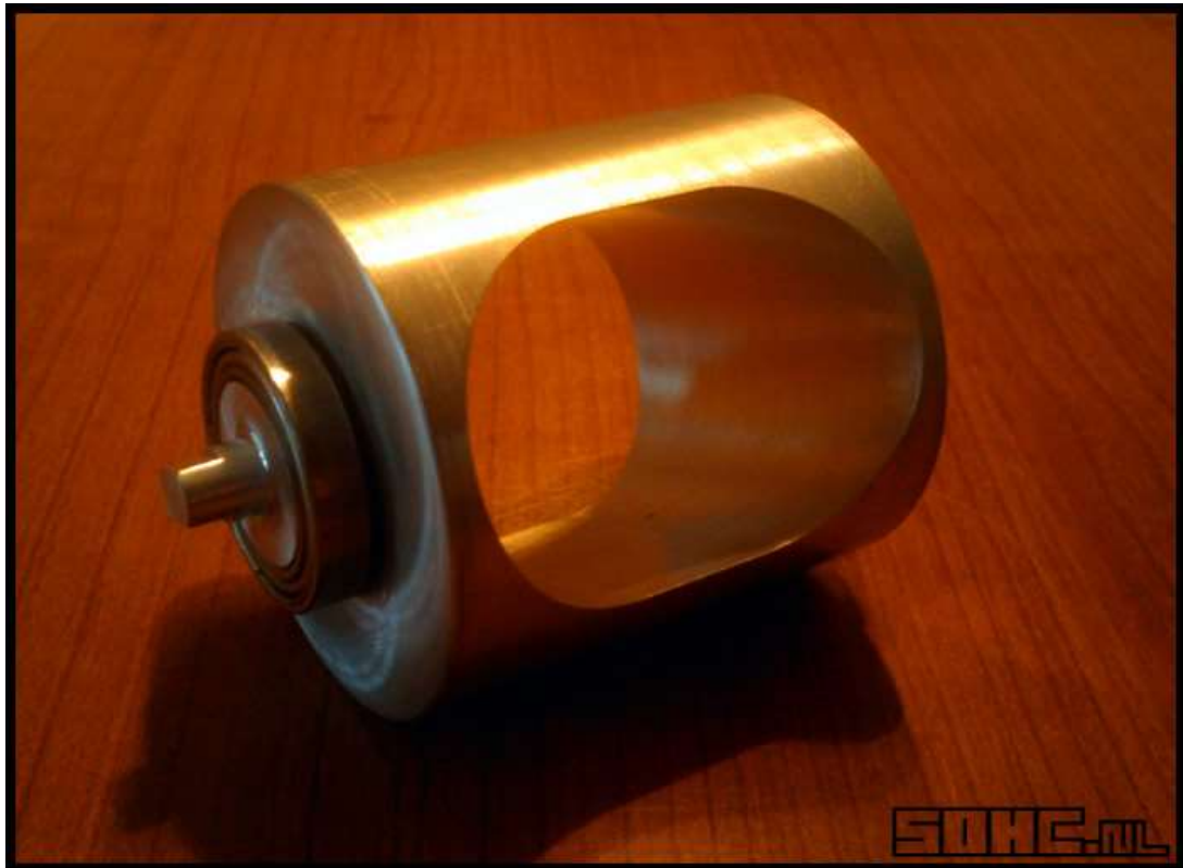
Obrázek 15: Akční člen škrťení soudečkové klapky – soudeček. [ 8 ]
