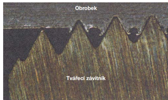
Obr. 20 Tváření závitu [28]
