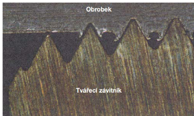
Obr. 20 Tváření závitu [28]
