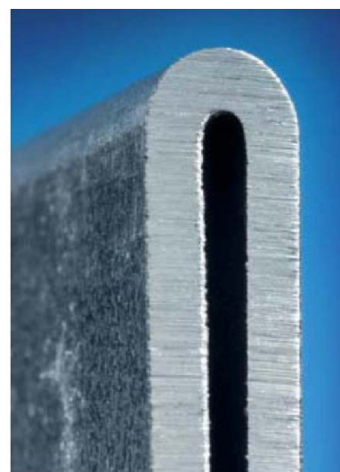
Obr. 35 Ohyb oceli Docol Roll 1000 [9]
