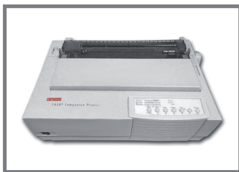
Obr. 7 Jehličková tiskárna LA30
