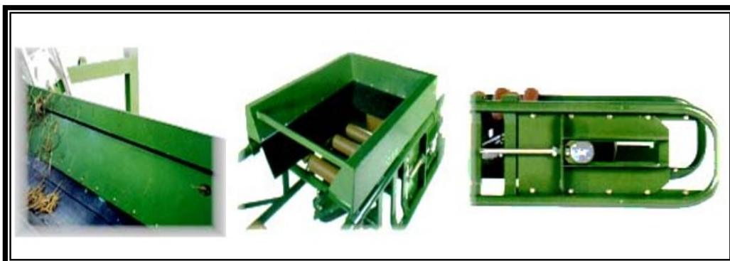
Obr. 1.7 Bočné vedenie, násypka a napínacia jednotka prenosného pásového dopravníka Zdroj: vlastné spracovanie podľa [1]
