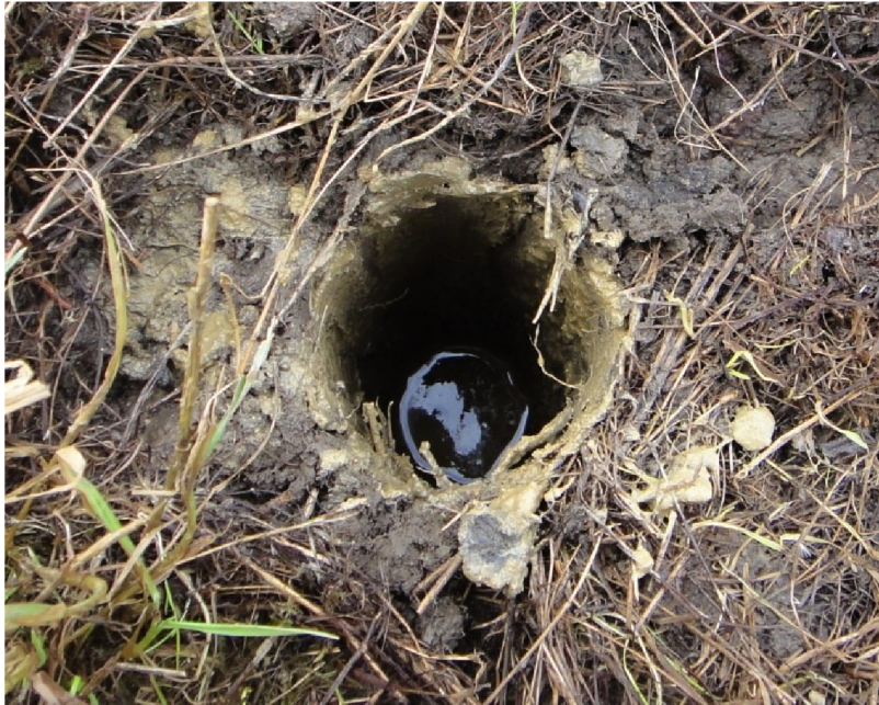
Obrázek 3 - Sonda před odstraněním vody kalovkou nebo čerpadlem (Bát'ková et al. 2013).
