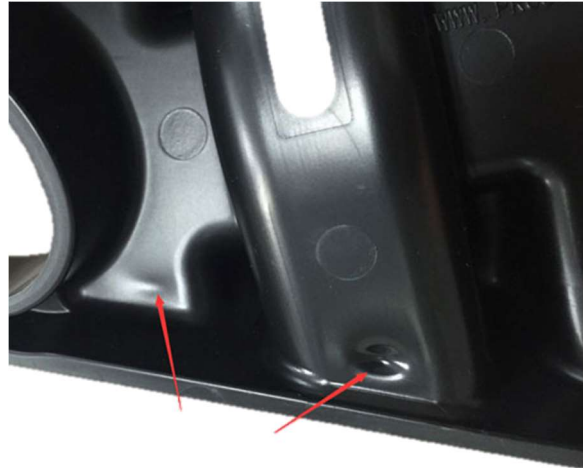
Obr. 44 Propadlina na výstřiku [68].
