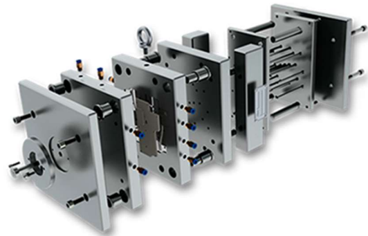
Obr. 21 Rozpad vstřikovací formy [38].
