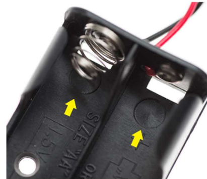
Obr. 26 Stopy po vyhození [47].
