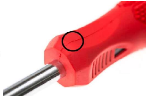
Obr. 24 Stopy po dělicí rovině [41].
