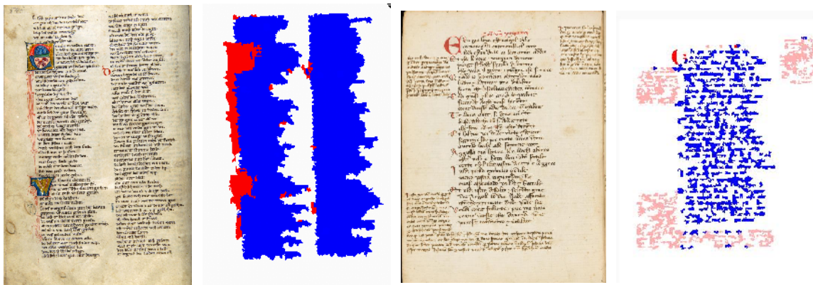
Obrázek 2.3: Ukázka segmentace stránek. Levý obrázek z dvojice je původní strana, pravý pak segmentace provedená pomocí neuronové sítě. Bílá značí stránku, červená dekorace a růžová komentáře (převzato z [6]).
