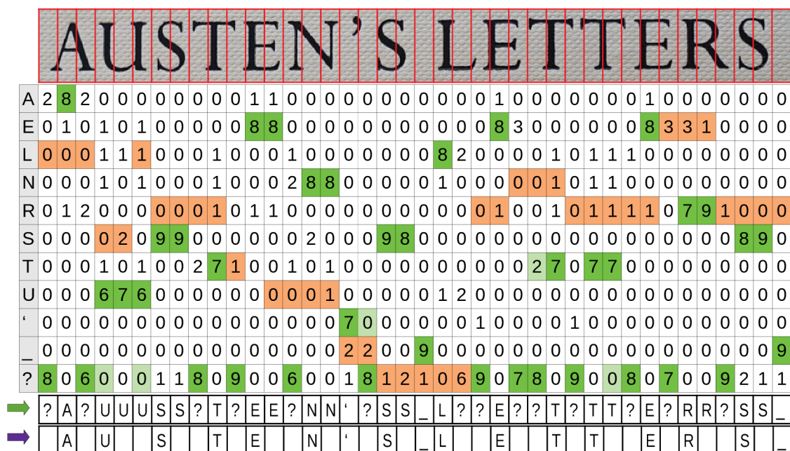
Obrázek 2.11: Získání přepisu při použití CTC vrstvy. Pravděpodobnostní matice P pro vstupní výřez má dimenzi T jako sloupce. Každý sloupec obsahuje pravděpodobnost výskytu (vynásobenou deseti) jednotlivých znaků v daném místě výřezu. Sytě zelená barva značí nejpravděpodobnější průchod, oranžová průchod jiný, byť málo pravděpodobný. Světle zelená naznačuje možnost záměny se sytě zelenou při zachování správného přepisu. Řádek označený zelenou šipkou představuje znaky nejpravděpodobnějšího průchodu. Výsledný přepis je na posledním řádku (fialová šipka).
