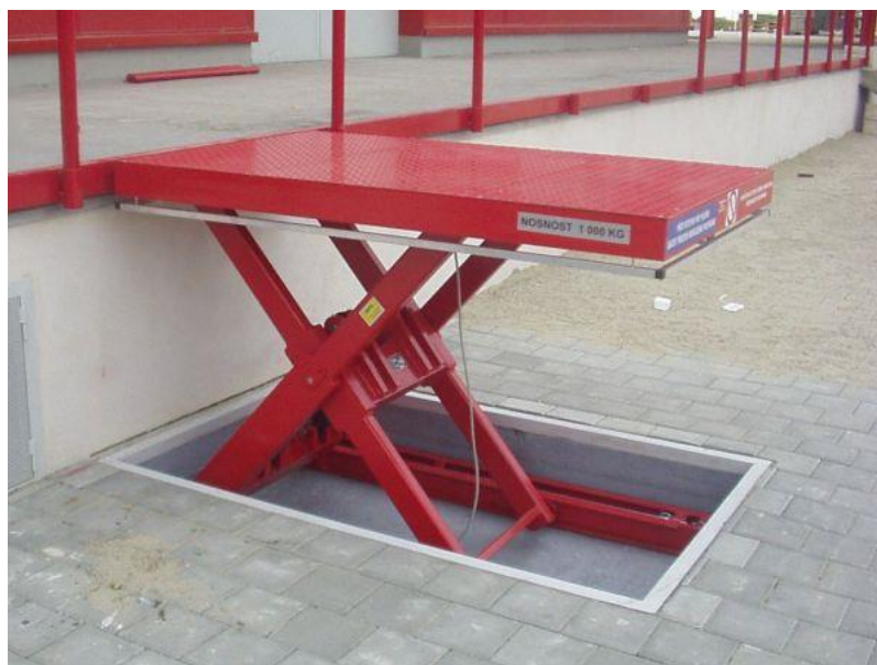
Obr. 5 Hydromotor pod úrovní podlahy [6]
