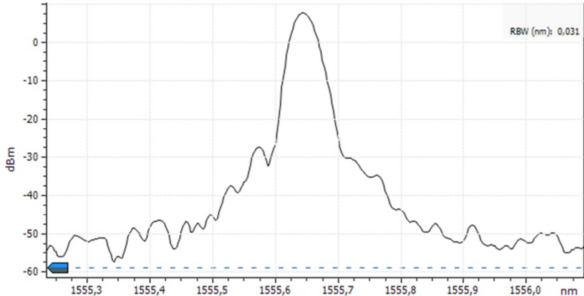
Obr. 6.4: Naměřené spektrum DFB laseru
