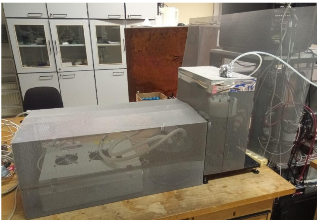
Obr. 15: Stínění AC zdroje, reaktoru a odstínění MS a OES přístrojů
