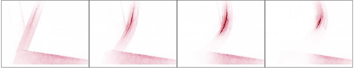
Obrázek 51: Sekvence snímků v inverzním vybarvení pro vzorek s 9*0,45 mm vláknovým kompozitem a pryskyřicí Dentapreg.
