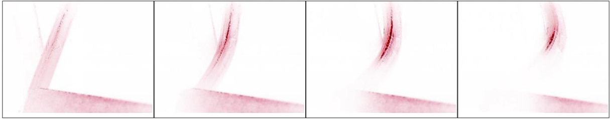
Obrázek 51: Sekvence snímků v inverzním vybarvení pro vzorek s 9*0,45 mm vláknovým kompozitem a pryskyřici Dentapreg.
