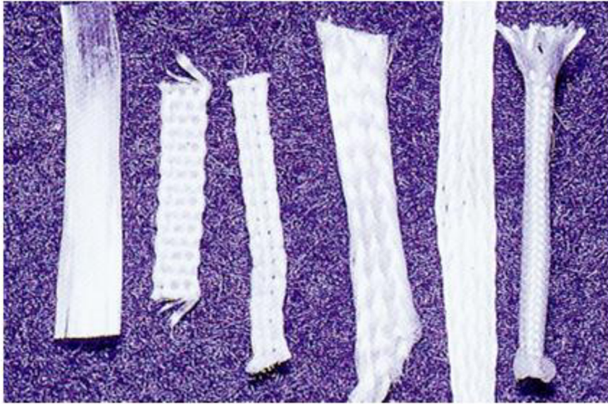
Obrázek 12: Základní typy splétaných, tkaných a jednosměrných vláknových výztuží [17].
