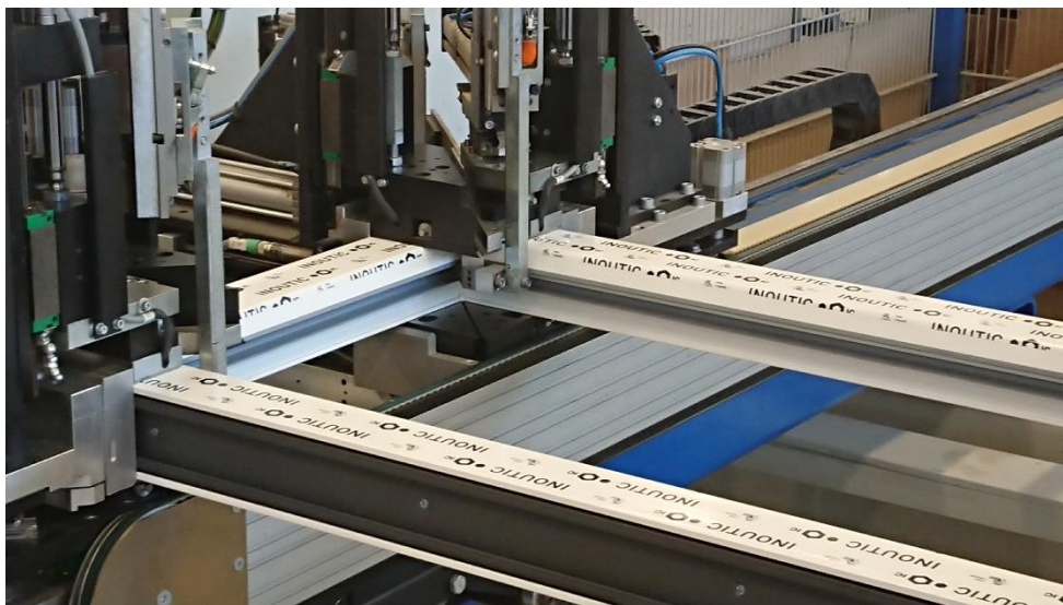
Obr. 3: Vzhled svářečky plastových profilů v chodu.
