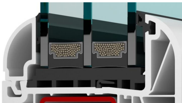
Obr. 10: Uspořádání v detailu distančního rámečku
