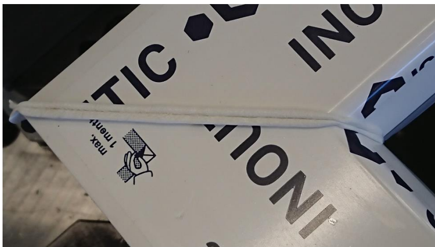
Obr. 4: Přetok okenního PVC profilu po svařování rámu
