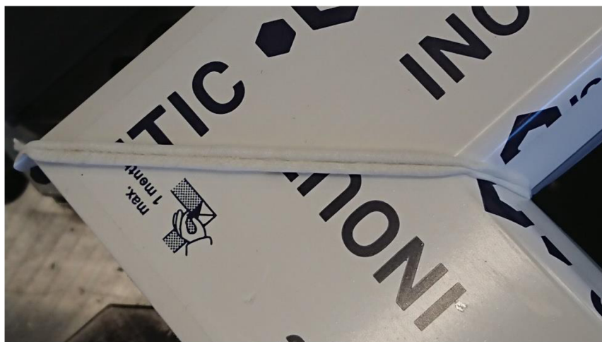
Obr. 4: Přetok okenního PVC profilu po svařování rámu
