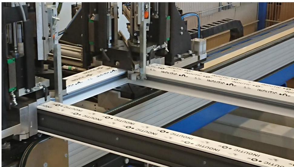
Obr. 3: Vzhled svářečky plastových profilů v chodu.
