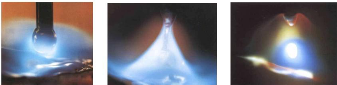
Obr. 7 Prenos kovu zľava: kvapkový, sprchový, impulzný [6].
