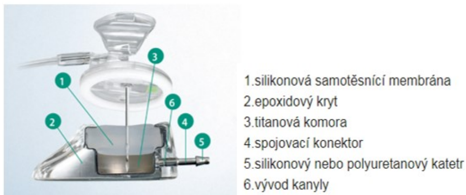
Obrázek 15 Složení intravenózního portu
