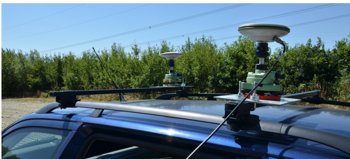
Obrázek 37 - Detail umístění GPS roverů
