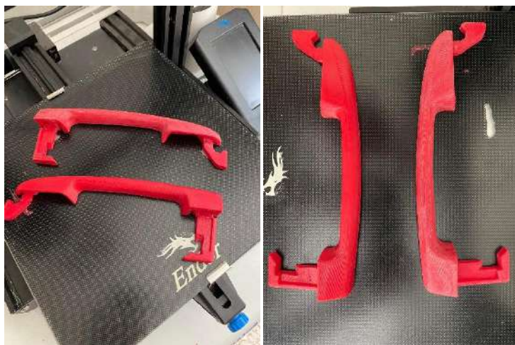
Obr.28 Porovnanie opracovaného povrchu modelu (hore, vpravo) s neopracovaným (PET-G).
