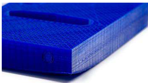
Obr.4 Deformácia pri tlači modelu [8].
