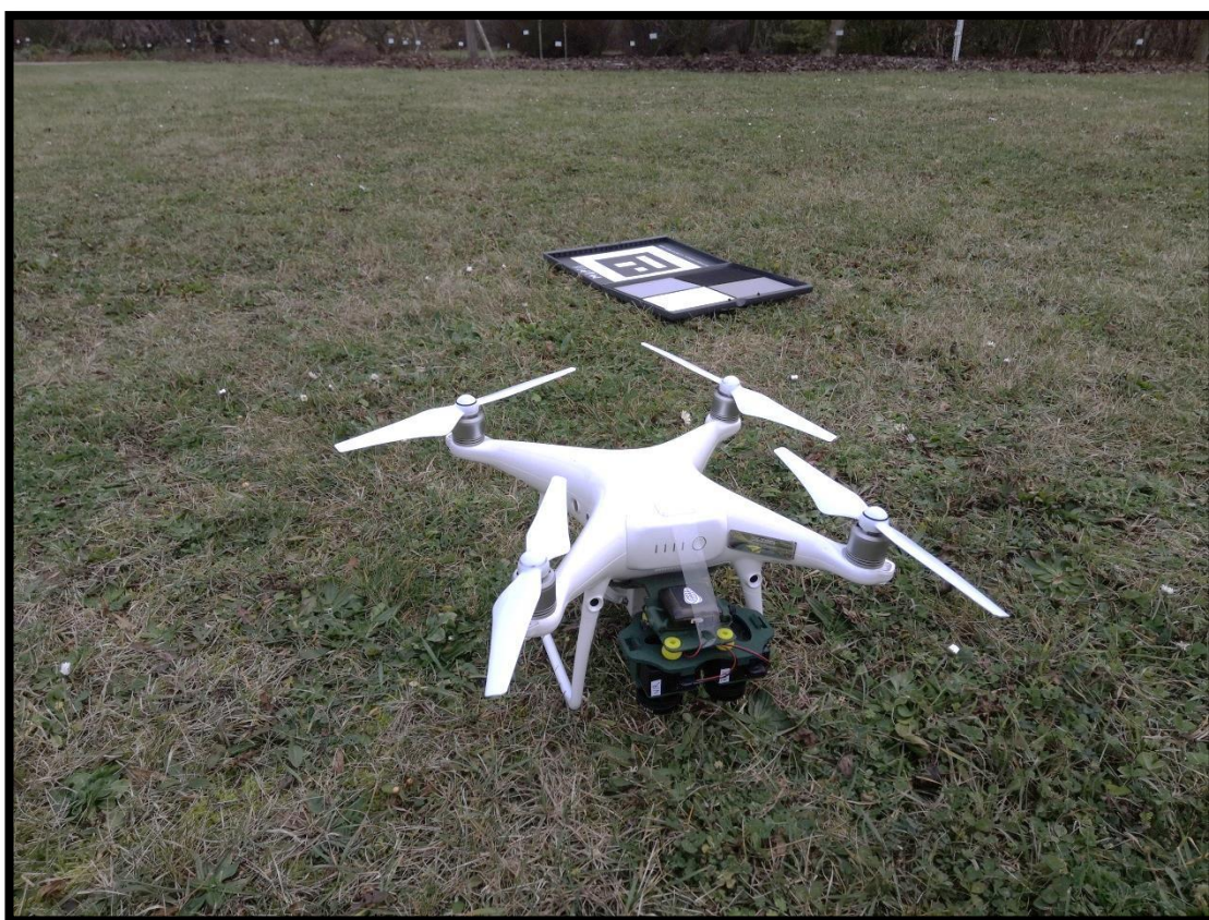
Obrázek 7: Využitý systém UAV (DJI Phantom 4 + MAPIR Survey 3)
