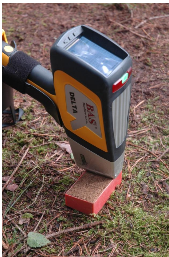
Obr. 12: Spektrální analýza vzorku půdy či sedimentu v terénu.
