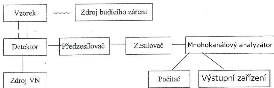
Obr. 7: Schéma aparatury pro energiově disperzní rentgenfluorescenční analýzu (Helán a kol., 1997).
