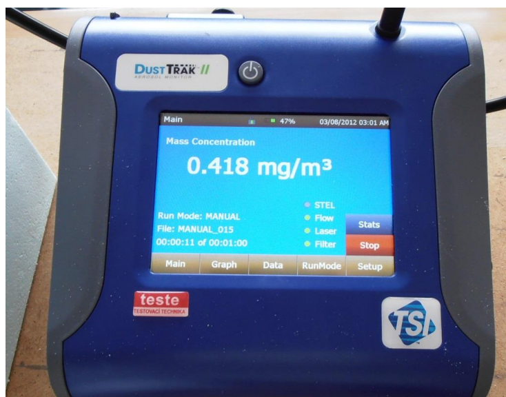
Obrázek 29 - Měřící přístroj Dust Trak 8530 II
