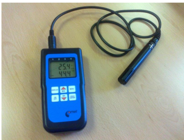
Obrázek 30 - Commeter D4141, Zdroj: Autoři metodiky měření prašnosti v chovech drůbeže
