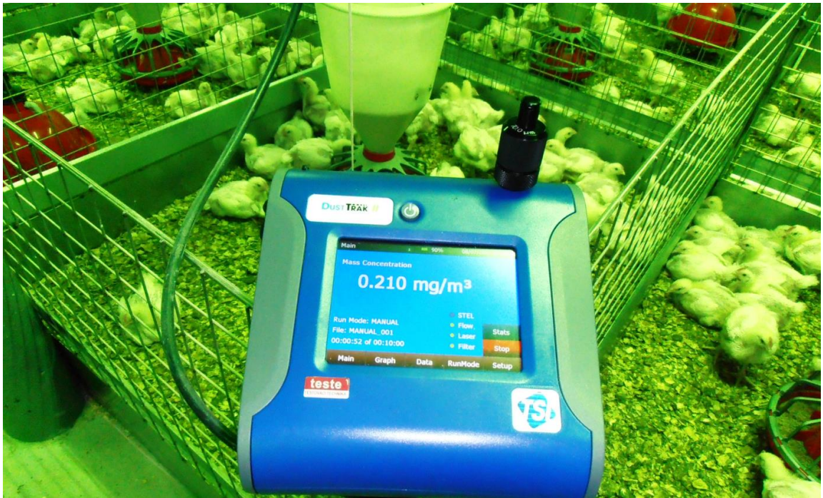
Obrázek 34 - Monitor aerosolů Dust Track II
