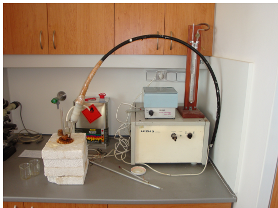
Obr. 12: Aparatura pro stanovení chladových parametrů nafty
