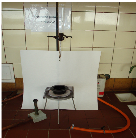
Obr. 11: Aparatura pro stanovení bodu vzplanutí v otevřeném kelímku dle Clevelanda
