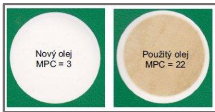
Obr. 3-20 Zkoušky kolorimetrií dvou turbínových olejů [22]
