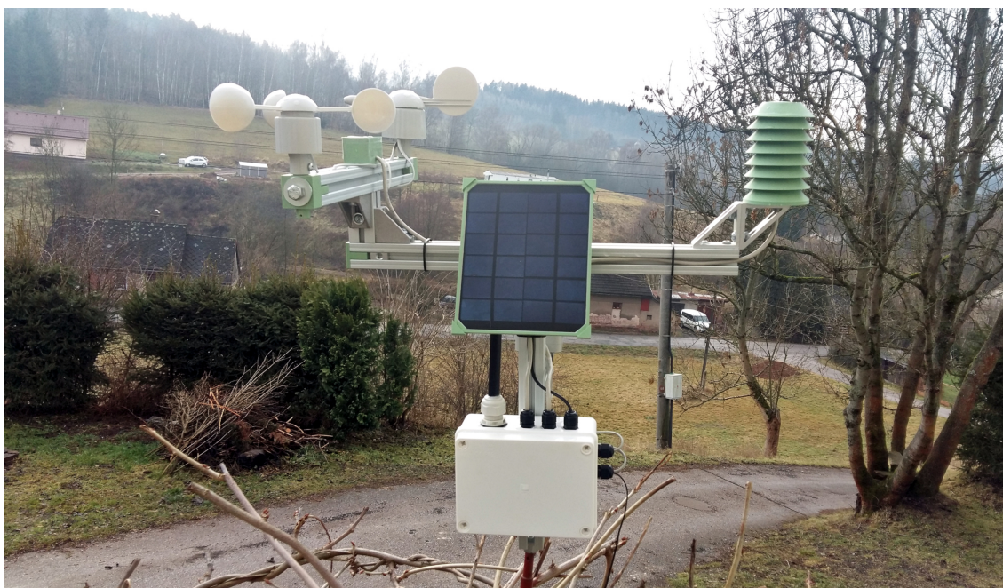
Obrázek 5.4: Meteorologická stanice č. 1 umístěná ve venkovním prostředí
