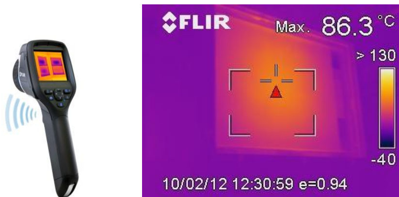
Obr. 6-2 Termovizní infракamera značky FLIR - vlevo, Snímek termokamerou pro používaný zářič Philips - vpravo (Zdroj: FLIR [ http://www.flir.com ])
