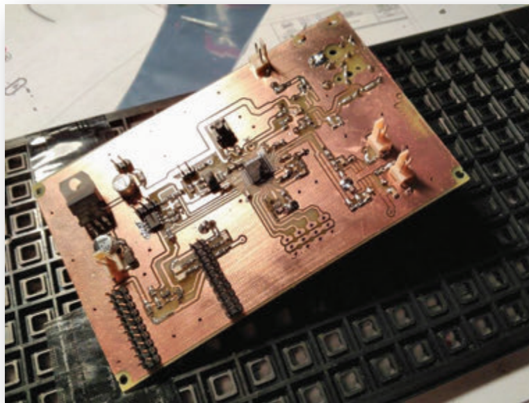
Obrázok 2.9 Prototyp DSP - vrchná strana dosky
