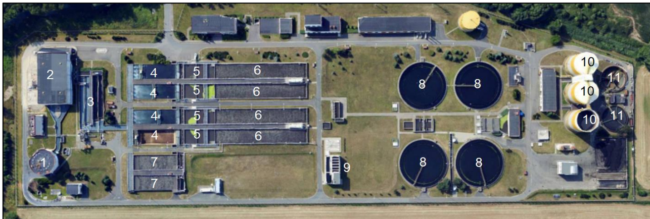
Obrázek 10 Rozložení jednotlivých objektů ČOV [34]
