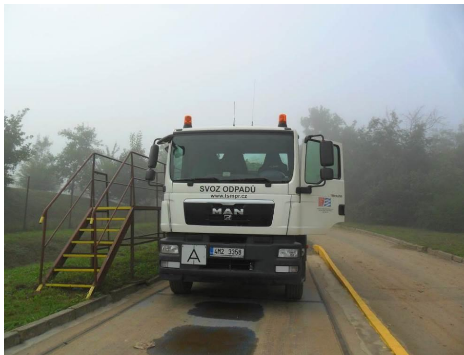
Obr. č. 26 – Váha na vážení hmotnosti přivezeného odpadu (Čoček, 2014)
