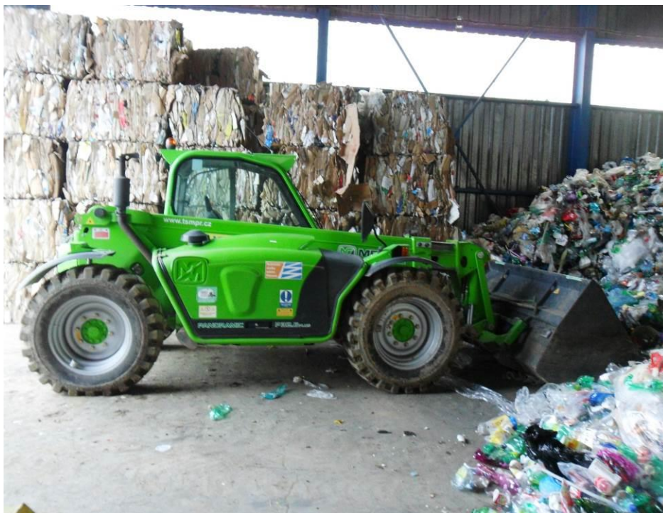
Obr. č. 14 – Manipulátor Panoramic P32.6 na nahrnování odpadů (Čoček, 2014)
