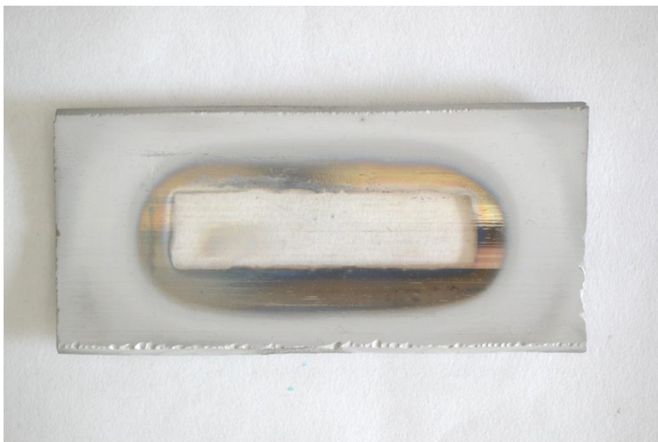
Obrázek 8: Zrcátko – cínová vrstva deponovaná na držák během experimentu.
