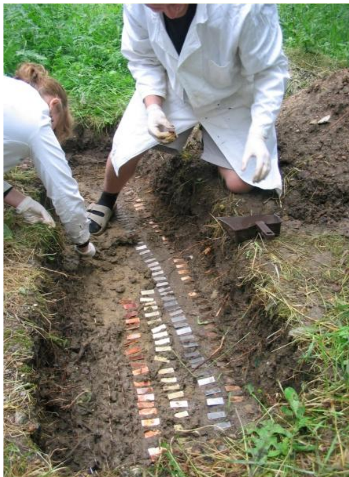
Obrázek 41: Ukládání vzorků do půdy na území města Brna, v prostorách FCH, VUT v Brně.
