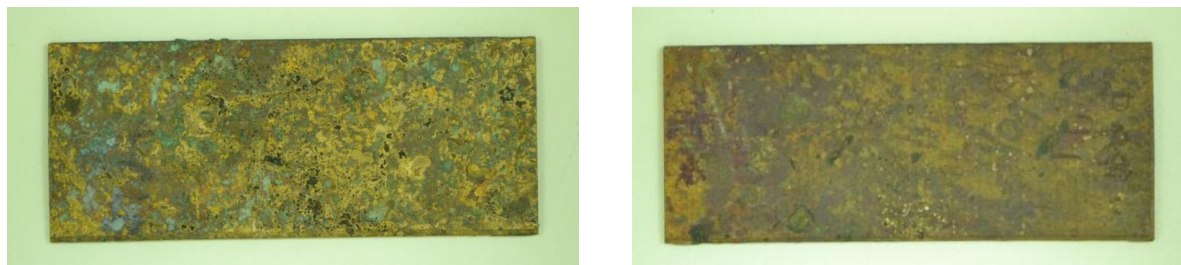
Obrázek 42: Dva vzorky, které byly vybrány jako referenční (vlevo korodoval v horizontální poloze, vpravo korodoval ve vertikální poloze) pro EDX a XRD analýzu.
