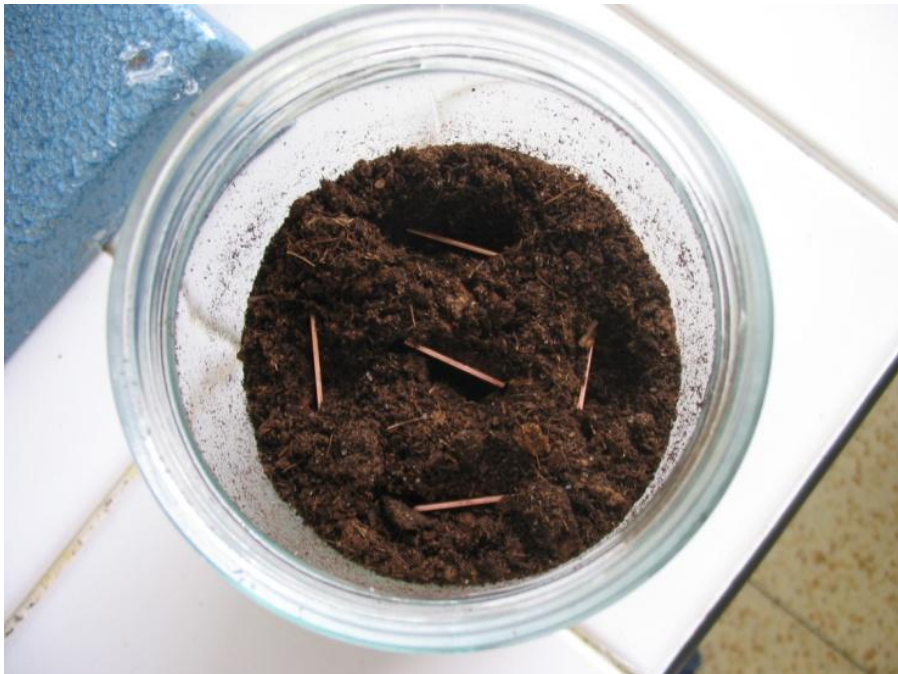
Obrázek v příloze 1: Kapitola 5.1, strana 36. Pět bronzových vzorků uložených v zakoupeném substrátu pro výsev a množení. Jedná se o simulaci podmínek tropického prostředí.
