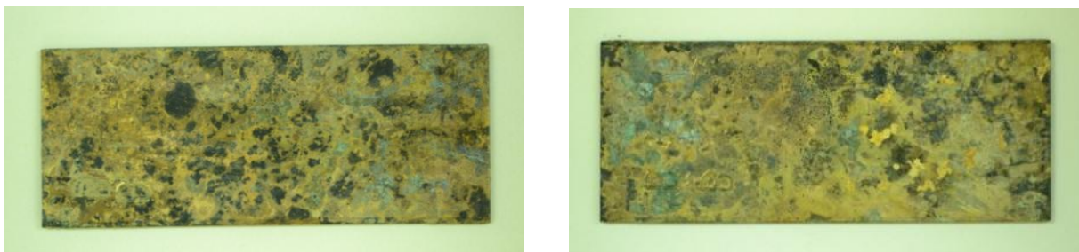
Obrázek 55: Dva vzorky, které byly vybrány jako referenční (vlevo korodoval v horizontální poloze, vpravo korodoval ve vertikální poloze) pro EDX a XRD analýzu.
