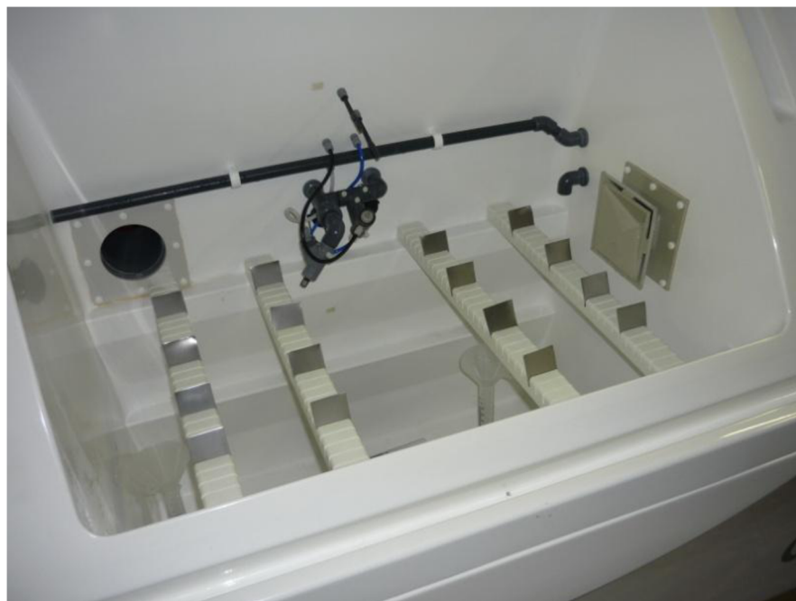
Obrázek v příloze 2: Kapitola 5.1, strana 36 a 37. Uložení Fe vzorků v korozní komoře před aplikací solanky. Stejným způsobem byly uloženy bronzové vzorky.
