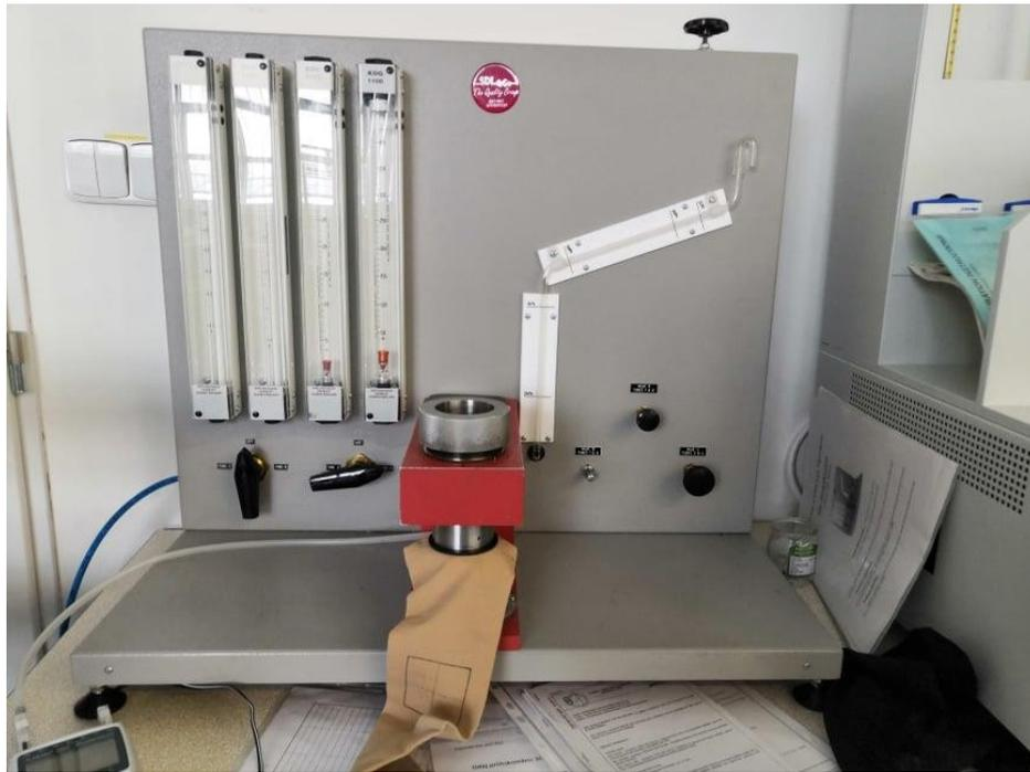
*Obrázek 17: SDL M021S Air Penetration device*
